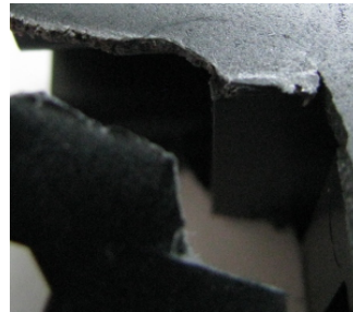
リブの喰いつきによる破損
